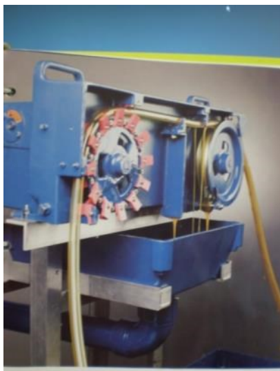
Zdjęcie 9. OILSKIMMERS urządzenie do odzysku oleju odpadowego z instalacji blokowych
