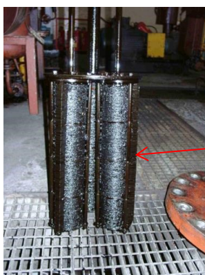
Zdjęcie 6. Widok wkładu filtra szczelinowego
